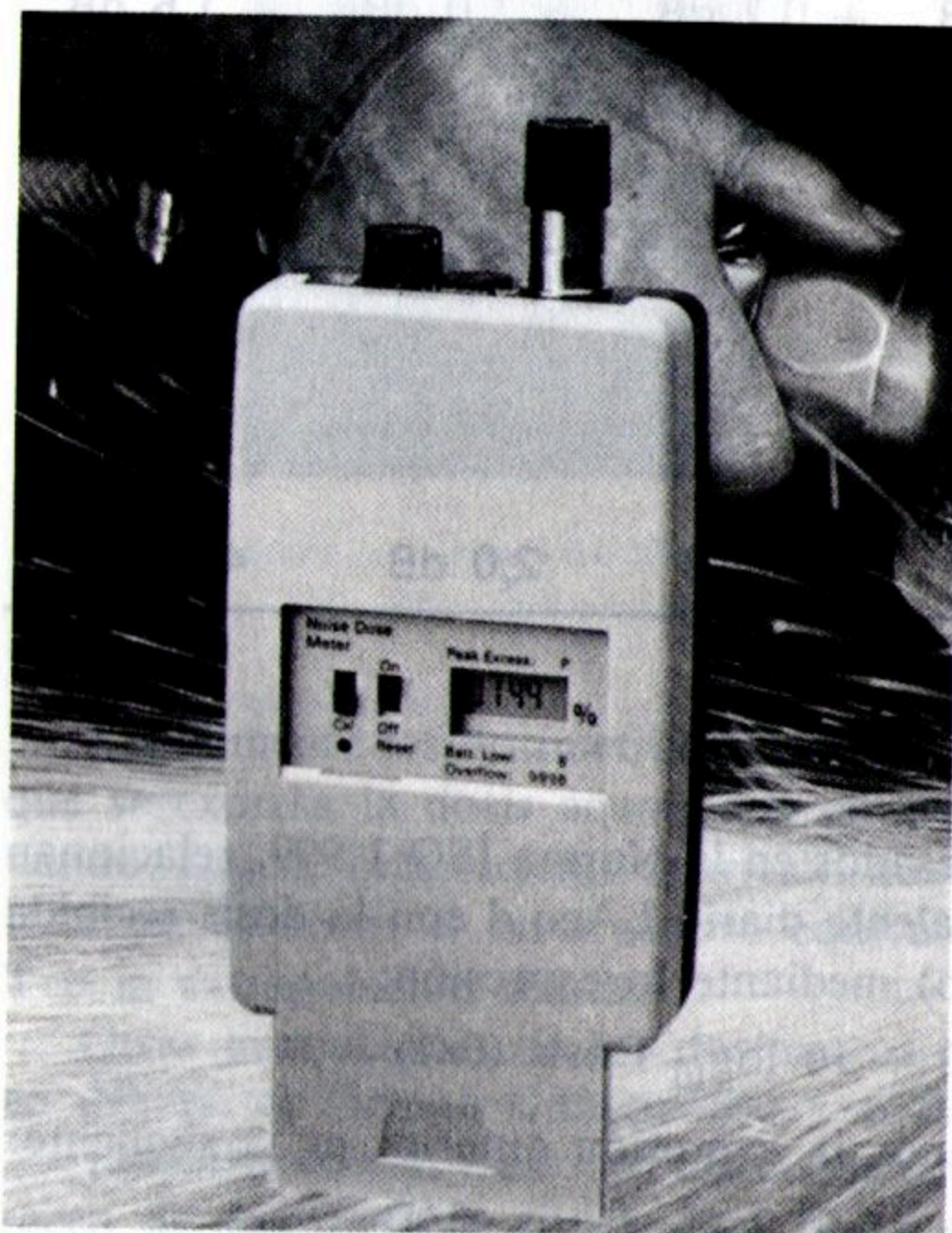
Figura 17.—Dosímetro de ruido.
